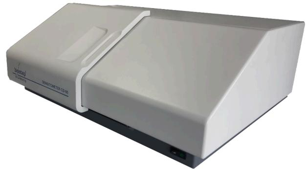
Zur quantitativen Bestimmung von Proben setzt das HPTLC-Densitometer CD60 die Flecken/Bänder der einzelnen Substanzen in eine Chromatogrammkurve um. Es misst die Absorption oder Fluoreszenz der getrennten Substanzen im Transmissions- oder Reflexionsmodus. Das HPTLC-Densitometer CD60 wird von der ProQuant-Software gesteuert, die auch eine quantitative Auswertung der erzeugten Daten ermöglicht.
